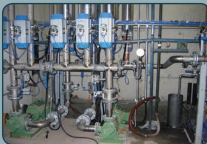
SPOLCHEMIE a.s., POLYESTERY, НАСОСНЫЕ АГРЕГАТЫ ТИПА MV
